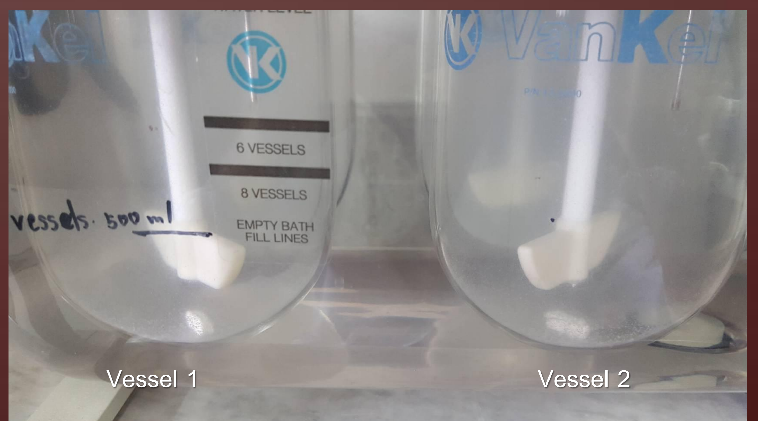
รูปที่ 1 ยาเม็ดแคลเซียมคาร์บอเนตที่ไม่แตกตัวหลังจากครบเวลาทดสอบการละลายของตัวยาใน vessel 1 และ 2
